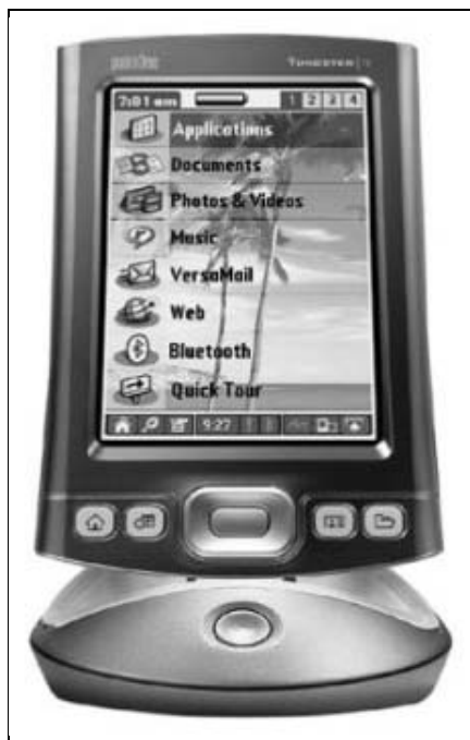
Bild 4: Die Palm USB-Docking-Station (Cradle) für die Modelle Tungsten T5 und E2 ist zugleich – wie die meisten Docking-Stationen – mit einer Ladefunktion für den Akkumulator des PDA ausgestattet.
