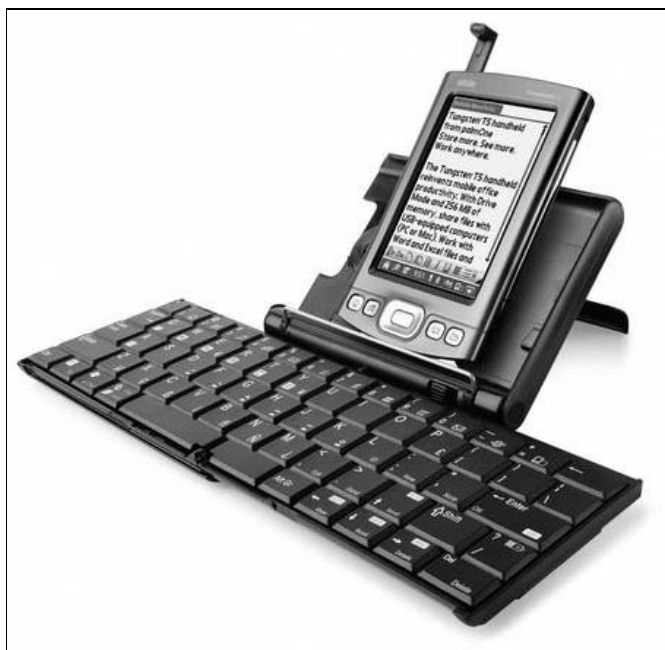
Bild 6: Mit einer faltbaren Tastatur kann wie auf einer üblichen Tastatur geschrieben werden.
