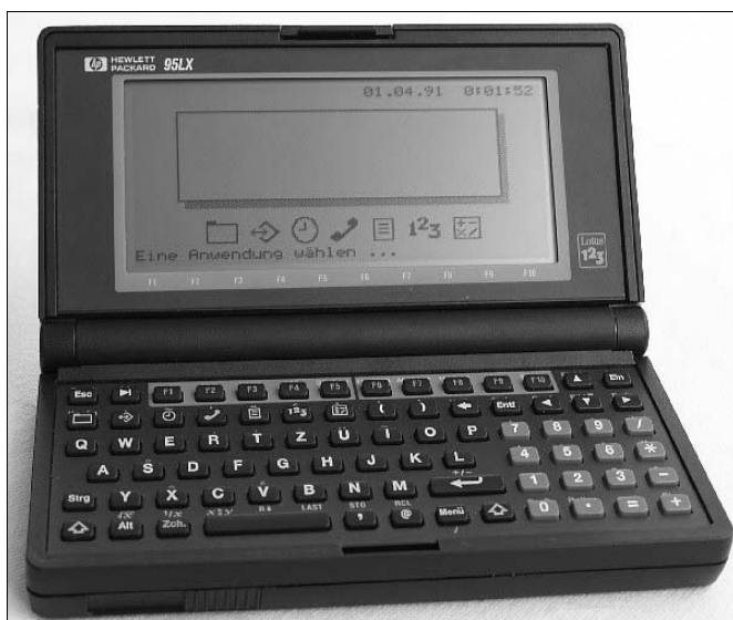
Bild 1 (links): Der HP-95LX (1991) war mit dem Betriebssystem MS-DOS ausgestattet und hatte standardmäßig das Tabellenkalkulationsprogramm Lotus 1-2-3 eingebaut.
