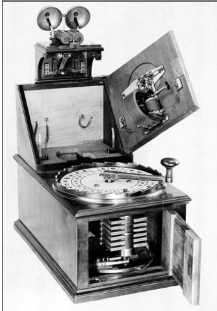
Bild 22: Ein Zeigertelegraf der Firma Siemens. Mithilfe der Kurbel wird auf den Buchstaben auf der Scheibe gezeigt, der übertragen werden soll.
